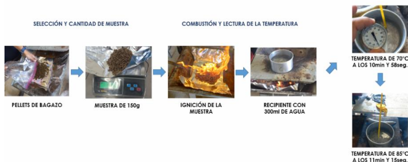
Figura 23. Combustión de Pellets de Bagazo palma + almidón Plátano. Fuente propia.
